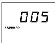
Au démarrage initial, ceci apparaîtra sur l'afficheur et le système indiquera quatre groupes de chiffres se succédant (p. ex. 100 ensuite 114 ensuite 28 ensuite 240). Ceci indique la version actuelle du logiciel et la tension d'entrée au système.
